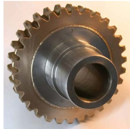
电子束焊接的蜗轮 CuSn-St
