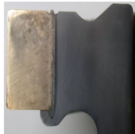
青铜和钢的焊接 焊接深度: 25mm
